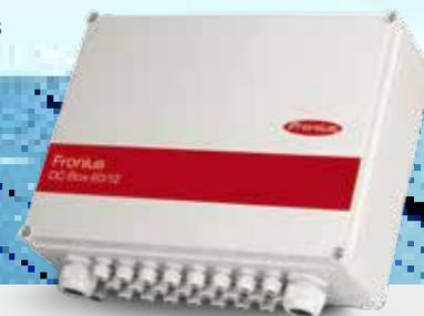
/ La Fronius DC Box 60/12 agrupa hasta 12 series fotovoltaicas de módulos con una corriente total máxima de 60 amperios. Adicionalmente a la función de concentración de series fotovoltaicas los fusibles integrados protegen el campo de módulo. La Fronius DC Box 60/12 permite además el montaje de un componente de protección contra sobretensiones montable sobre carril DIN según el tipo 1 o 2.
