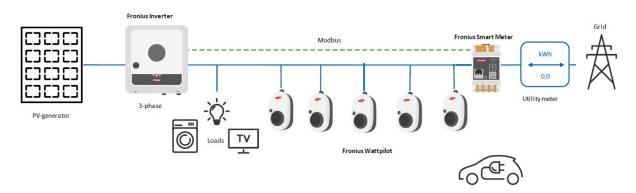
Inoltre, con l'utilizzo del Fronius Smart Meter IP e un inverter di terze parti, sarà possibile visualizzare il monitoraggio della ricarica del veicolo senza l'utilizzo di componenti aggiuntivi visti nel paragrafo 11.1:
